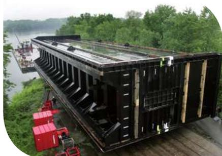
1 280 t, le plus gros colis transbordé via la rampe Ro-Ro de Lauterbourg : une porte d'écluse produite par l'entreprise Eiffel. Le port de Lauterbourg est par ailleurs équipé d'un portique pouvant lever des colis jusqu'à 200 tonnes.
