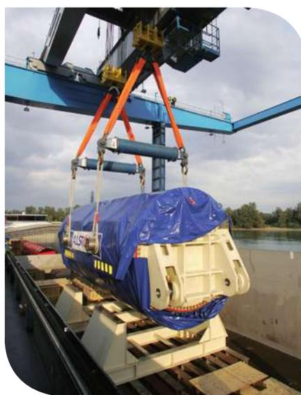
Le portique mixte (colis lourds/conteneurs) du terminal sud de Strasbourg permet de manutentionner des colis jusqu'à 460 t. Un itinéraire routier spécial a été mis en place entre Belfort et Strasbourg pour acheminer les turbines, rotors, stators, locomotives ou autres colis imposants.
