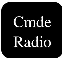
Implantée entre les deux pancartes précédentes, cette pancarte repère le point où la commande radio est lancée, pour les PN équipés de commande radio à distance.
