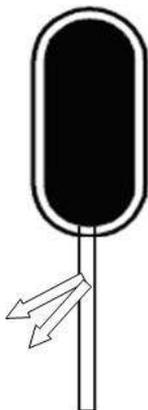
A la sortie d'un groupe de voies convergentes, au lieu d'un signal par voie, il peut n'être fait usage que d'un seul signal qui, s'adressant à l'ensemble de ces voies, est appelé « signal de groupe »
