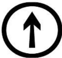
Lorsqu'une aiguille en pointe, aiguille de bifurcation par exemple, se trouve entre le TIV à distance et l'origine de la partie de voie à franchir à vitesse limitée, il est fait usage, sur la branche de l'itinéraire non concerné par la limitation temporaire de vitesse, d'un tableau blanc à flèche verticale noire, de forme circulaire, éclairé la nuit ou réflectorisé, implanté en talon de l'aiguille.
