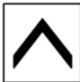
Si cela est nécessaire, pour repérer spécialement le point où l'arrêt est imposé aux mouvements exécutés en direction des croisements de sortie d'un faisceau de voies convergentes, il est fait usage, pour chacune des voies du faisceau d'un chevron pointe en haut, non éclairé la nuit, placé à droite de la voie à laquelle il s'adresse (si cela est nécessaire le chevron pointe en haut est complété par l'indication du numéro de la voie), en talon de l'aiguille de sortie correspondante.
