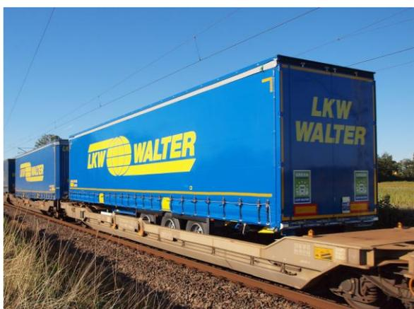
Figure 82 : Exemple du transport d'une semi-remorque non préhensible sur un plateau NIKRASA (source NIKRASA)
